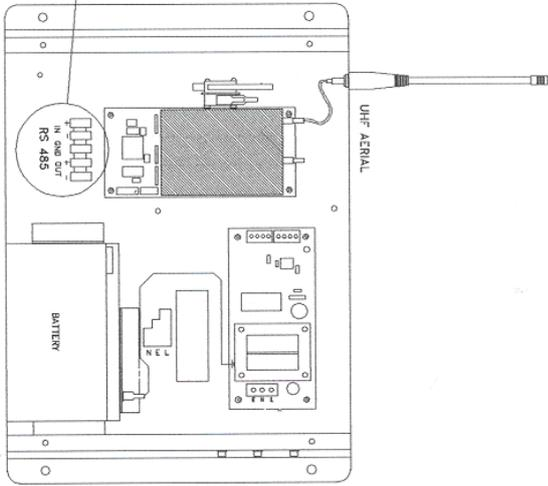
SCREEN OF CABLE TO BE EARTHED AT ONE CONTROL PANEL ONLY.
